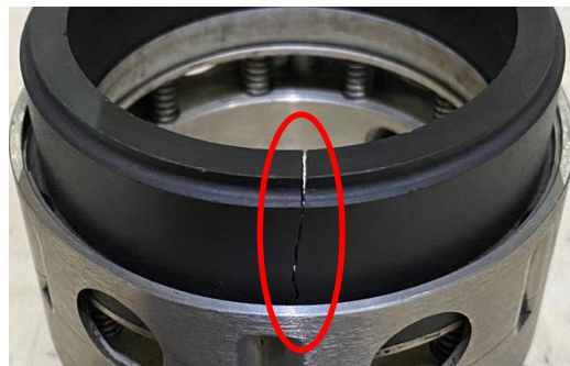
Gambar 4.10 Crack pada Carbon Mechanical Seal
