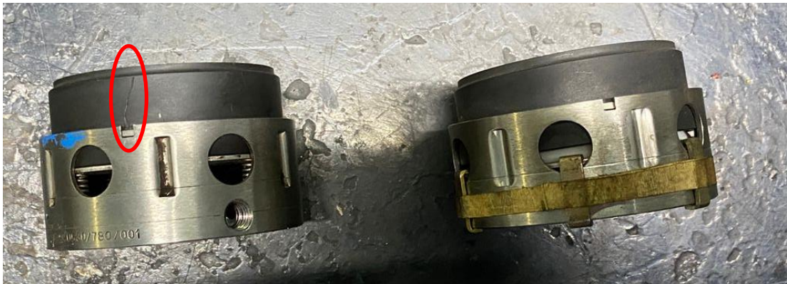
Gambar 4.11 Carbon Seal rusak (kiri) vs Carbon Seal baru (kanan)
