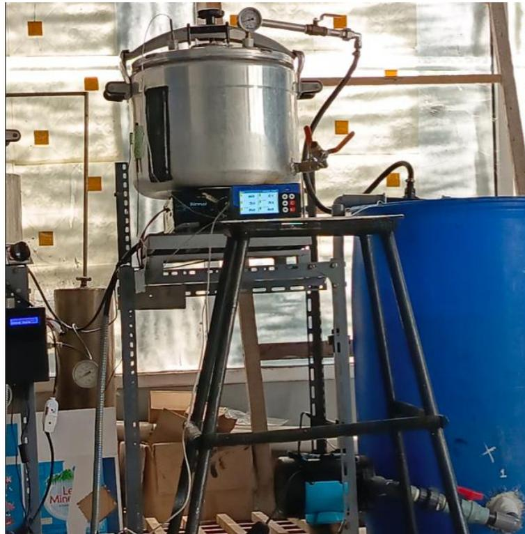
**Gambar 4.1** *Vacuum evaporator* dengan Kontrol ESP32
