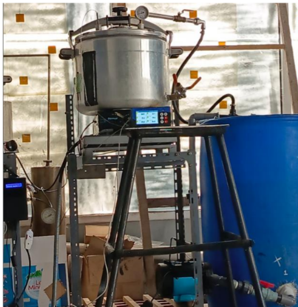
Gambar 4.1 Vacuum evaporator dengan Kontrol ESP32
