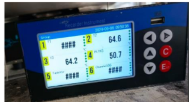
Gambar 3.6 Data logger dan Thermocouple
