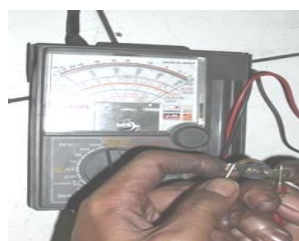
Gambar 4.10 Pengecekan menggunakan multi tester
