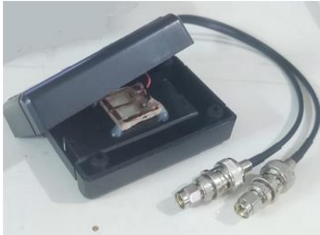
Gambar 2 Sensor Semikonduktor ZnO-Ag setelah Fabrikasi
