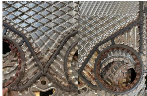
Gambar 4.7 Keausan Gasket pada PHE (E-321A)
