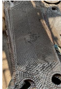
Gambar 4.4 Fouling (Pengotoran) pada PHE (E-321A)
