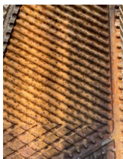
Gambar 4.6 Korosi pada Plate Heat Exchanger (E-321A)
