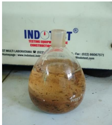
Gambar 13. Pengujian Berat Jenis Sumber : Dokumentasi Pribadi, 2018
