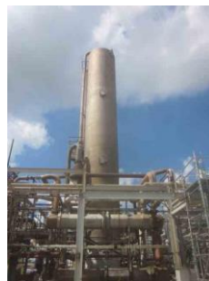
Gambar 4.1 Bejana Debutanizer pada Pabrik Kimia (Sumber: www.phxequip.com )
