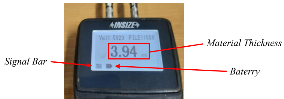
Gambar 4.3 Tampilan Ultrasonic Thickness pada saat Percobaan
