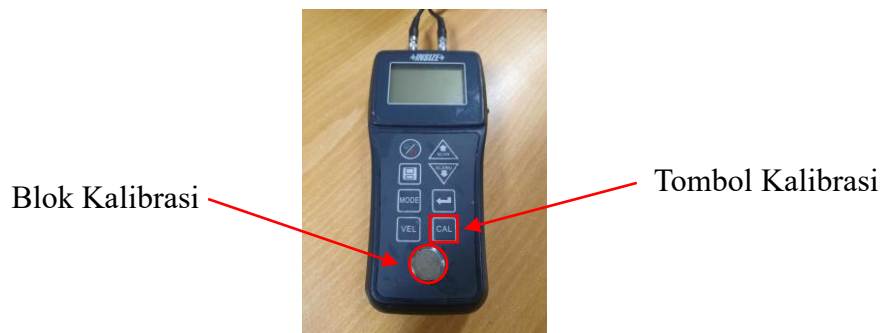
Gambar 4.2 Letak Blok Kalibrasi dan Tombol Kalibrasi
