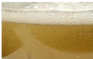
Gambar 2.19 Gelembung Udara Pada Proses Nucleation [24]
