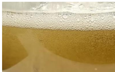
Gambar 2.19 Gelembung Udara Pada Proses Nucleation [24]
