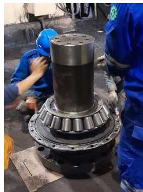
Gambar 4.5 Cleaning Permukaan Dalam Bearing
