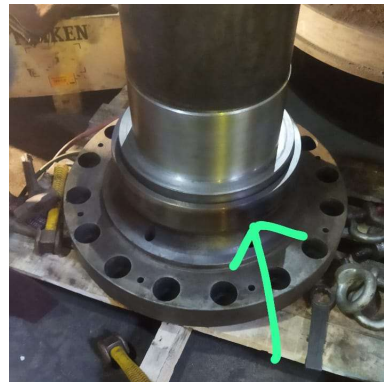
Gambar 4.6 Letak Shaft Sleeve (Sumber: Dokumen Pribadi)
