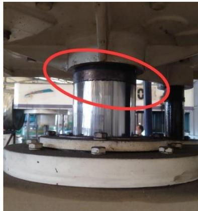
**Gambar 4.6** Kebocoran pada hidrolik
