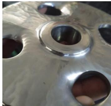
**Gambar 4.3** *Disk blade* mengalami kerusakan
