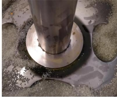
**Gambar 4.4** *Disk blade* baru yang sudah terpasang
