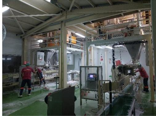
**Gambar 2.11** Unit Pengemasan Tepung Konsumsi Karung
