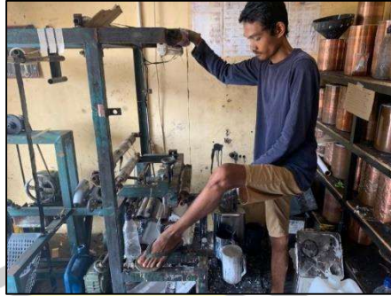
Gambar 5. Pemasangan Master Cetakan
