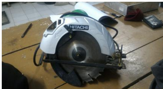
Gambar 3.3 Mesin Gergaji Kayu Sumber: Dokumentasi penulis, 2017
