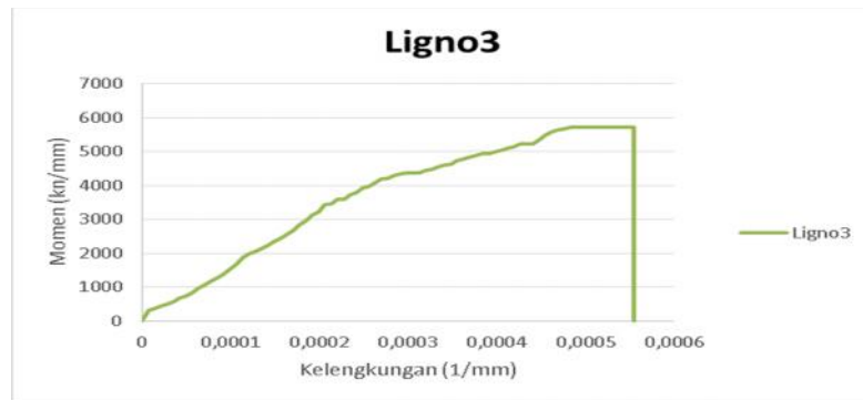
Gambar 5.16 Grafik hubungan momen dengan kelengkungan Ligno3 Sumber : Analisis Penulis, 2017
