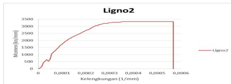
Gambar 5.14 Grafik hubungan momen dengan kelengkungan Ligno2 Sumber : Analisis Penulis, 2017
