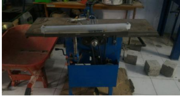
Gambar 3.4 Mesin Penyerut Sumber: Dokumentasi penulis, 2017
