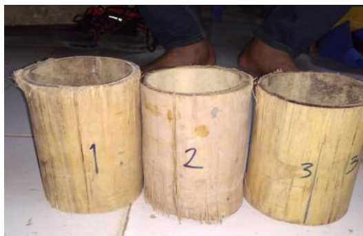
Gambar 3.9. Benda Uji Pendahuluan Tekan Bambu Sumber : Dokumentasi penulis
