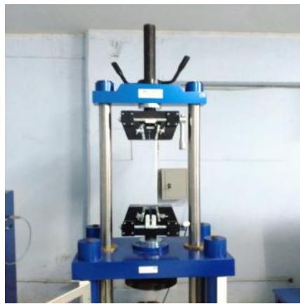
Gambar 3.7 alat uji Tarik ( Universal testing machine ) Sumber: Dokumentasi penulis, 2017
