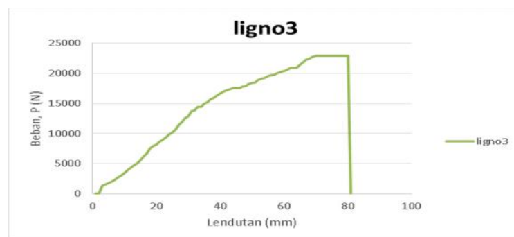
Gambar 5.15 Grafik hubungan beban dengan lendutan Ligno3 Sumber : Analisis Penulis, 2017
