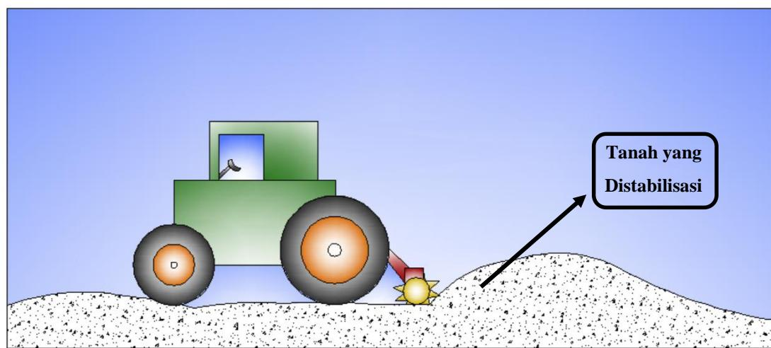
Gambar 5.21 Penggemburan Tanah Dilakukan dengan Alat Berat *Land Roller*
