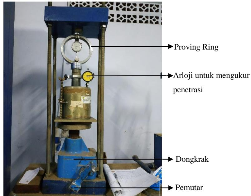
Gambar 5.15 Alat Pengujian CBR
