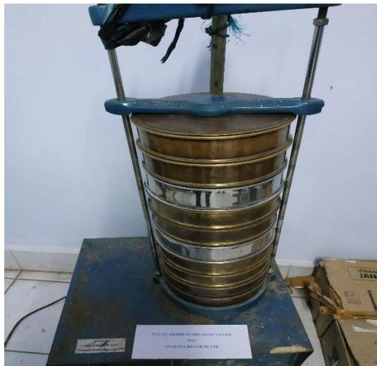
Gambar 5.8 Pengujian Analisa Butir Tanah
