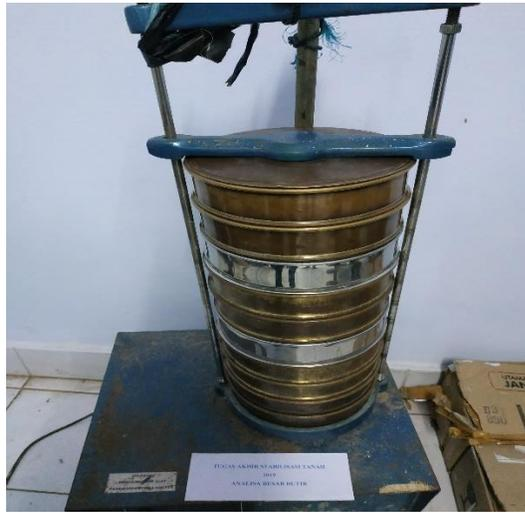
Gambar 5.8 Pengujian Analisa Butir Tanah
