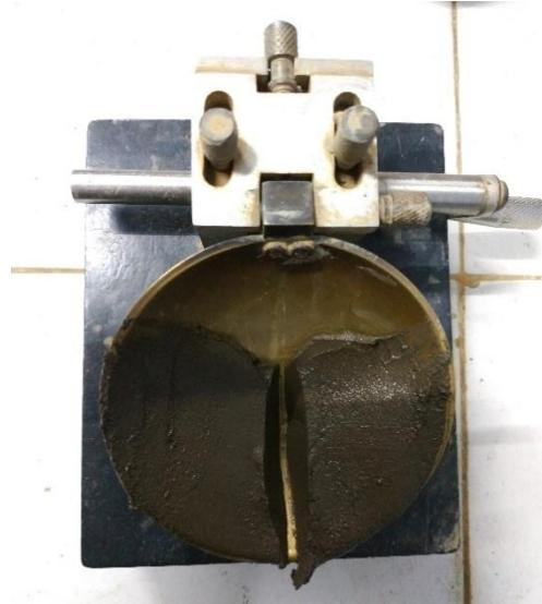
Gambar 5.5 . Pengujian Batas Cair
