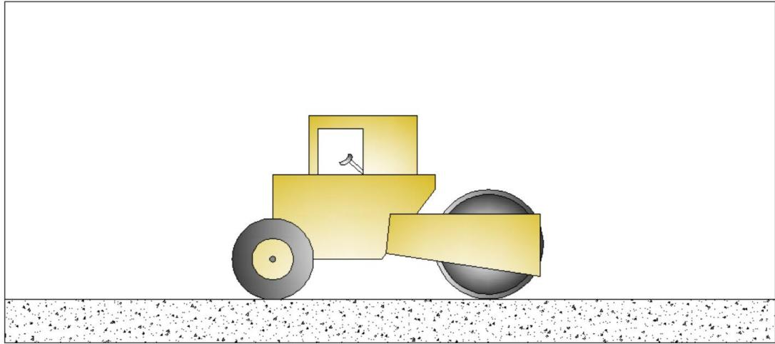
Gambar 5.23 Proses Pemedatan Dilakukan dengan Alat Berat *Roller Truck*
