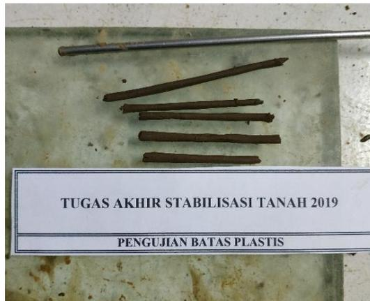
Gambar 5.7. Pengujian Batas Plastis Tanah
