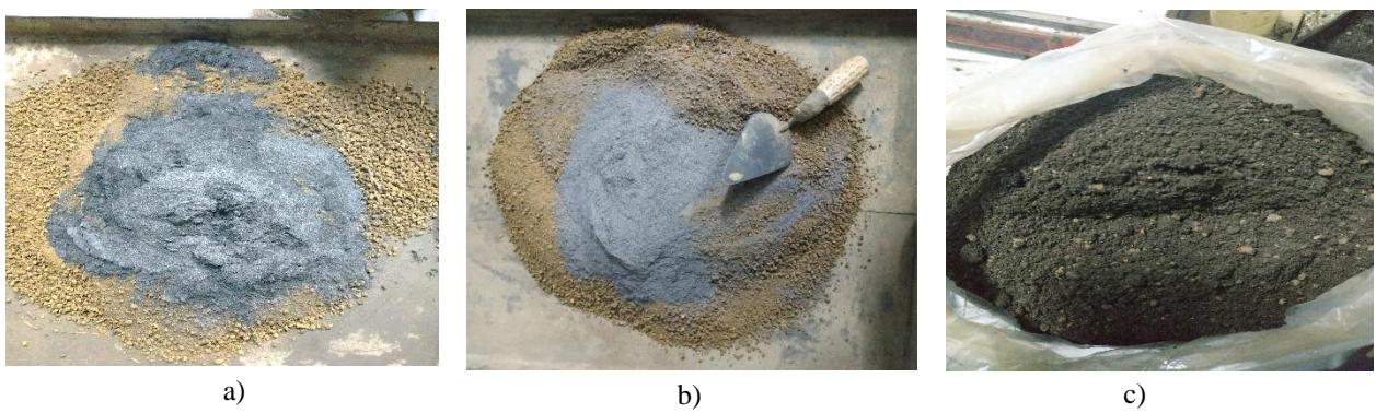
Gambar 5.14 a) Pencampuran Tanah dengan 5 % Abu Daun Bambu, b) Pencampuran Tanah dengan 10% Abu Daun Bambu c) Pencampuran Tanah dengan 15 % Abu Daun Bambu
