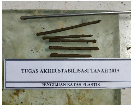
Gambar 5.7. Pengujian Batas Plastis Tanah
