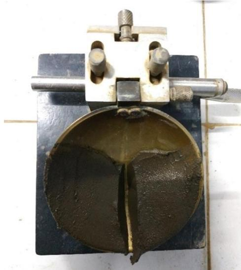
Gambar 5.5 . Pengujian Batas Cair
