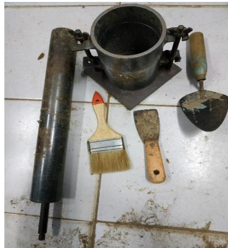
Gambar 5.10 Alat Pengujian Pemadatan
