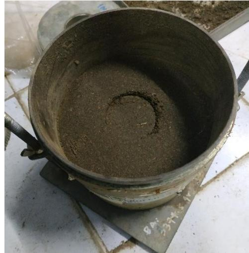
Gambar 5.16 Kondisi sempel tanah setelah pengujian CBR
