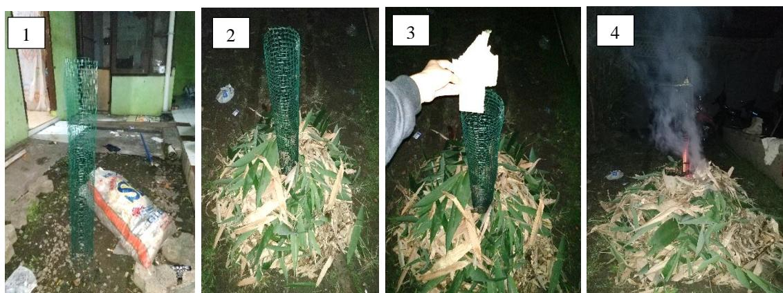
Gambar 4.1 Proses Pembakar Abu Daun Bambu
