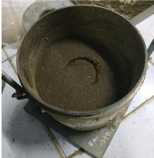
Gambar 5.16 Kondisi sampel tanah setelah pengujian CBR
