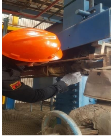
Gambar 4.14 Pemeriksaan Rotating Chain , dan Pemeriksaan Gland Packing
