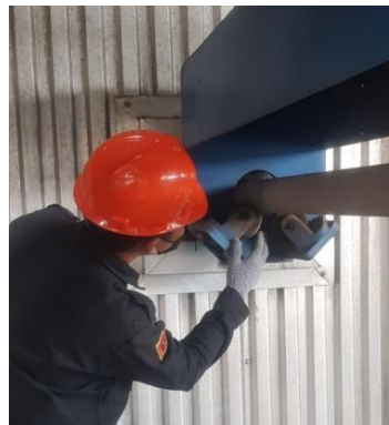
Gambar 4.18 Pemeriksaan Rolling Bearing
