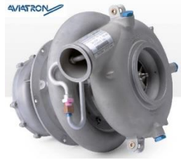
Gambar 3. 13 Air Cycle Machine pada Pesawat Udara (Sumber:aviatron.com)
