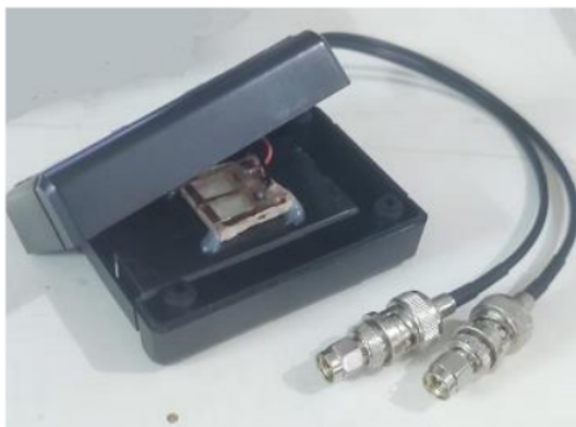
Gambar 4.1 Sensor Semikonduktor ZnO-Ag setelah Fabrikasi
