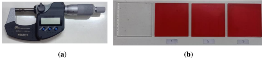
Gambar 3.14 (a) Mikrometer Digital (b) Sampel Uji Akrilik Tanpa Lapisan, Akrilik 3 Lapisan, Akrilik 7 Lapisan, dan Akrilik 7 Lapisan
