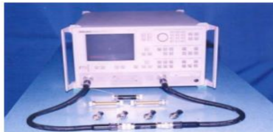
Gambar 2.7 Pengoperasian VNA Menggunakan Kabel Koaksial [25]
