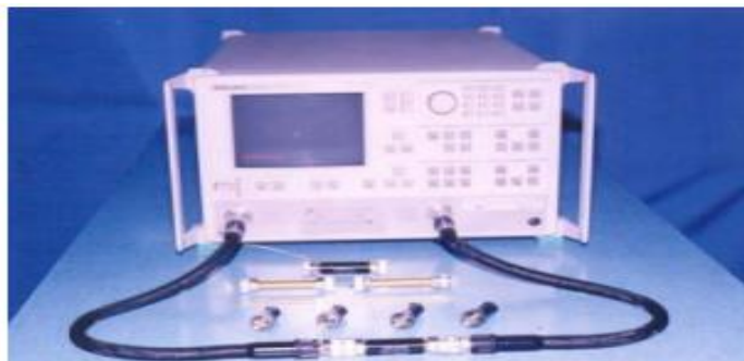
Gambar 2.7 Pengoperasian VNA Menggunakan Kabel Koaksial [25]
