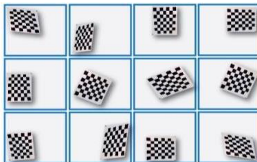
Gambar 3.5 Sudut dan jarak pada pengambilan citra kalibrasi
