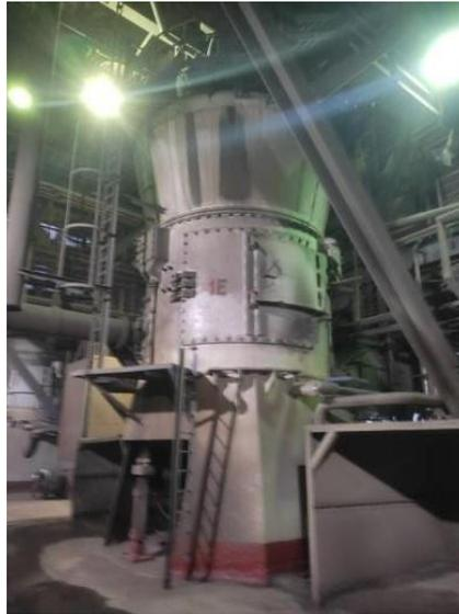
**Gambar 3.13** Pintu Akses Besar Pada *Intermediate Housing*
