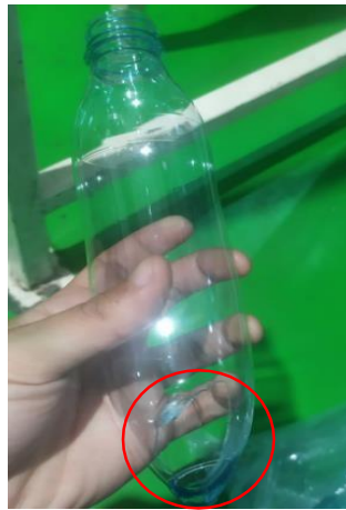
Gambar 4.18 Gagal Blowing pada bagian bottom
