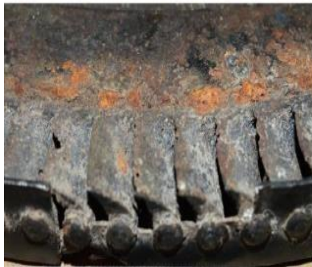
Gambar 5. 9 Bagian Sudu Turbin Yang Terkena crack
