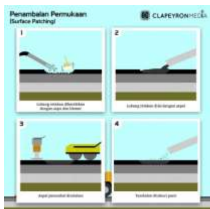
Gambar 5.9 Penambalan Permukaan (sumber: Clapeyron)
