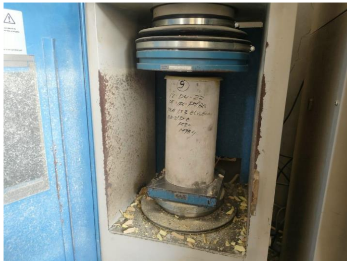
Gambar 4.2 Uji Kuat Tekan Beton
