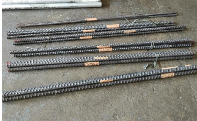
Gambar 4.4 Tulangan yang Di Gunakan Pada Proyek Gereja Katolik SPMBG
