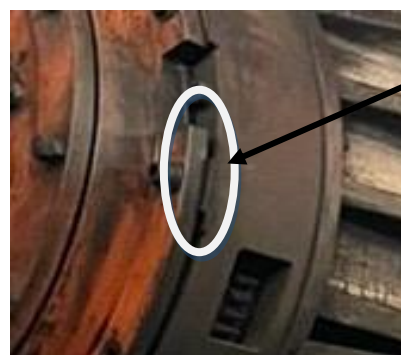
Gambar 4.3 Letak Pengecekan Clearance pada Sistem Rem
