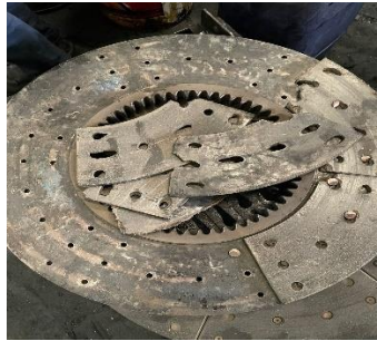
Gambar 4.4 Kondisi Kampas Brake yang mengalami Pecah
