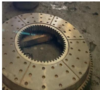
Gambar 4.5 Kondisi Kampas Brake Normal
