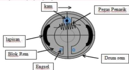
Gambar 2.1 Ilustrasi rem blok ganda
