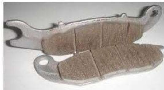
**Gambar 2. 4 Rem Berbahan Baku Asbestos**
