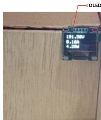
Gambar 4.6 Pengujian Sensor Arus Menggunakan OLED
