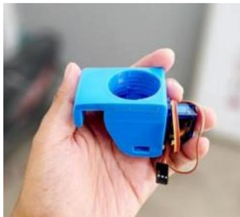
Gambar 2.3 Motor Servo dengan Mekanik Pakan [20]
