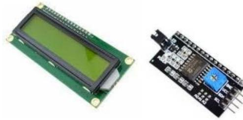
Gambar 2.5 Bentuk LCD 16x2 + I2C [20]
