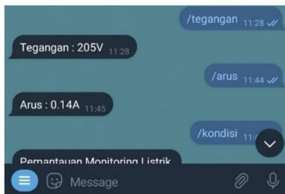
Gambar 4. 11 Tampilan Monitoring perparameter pada Bot Telegram
