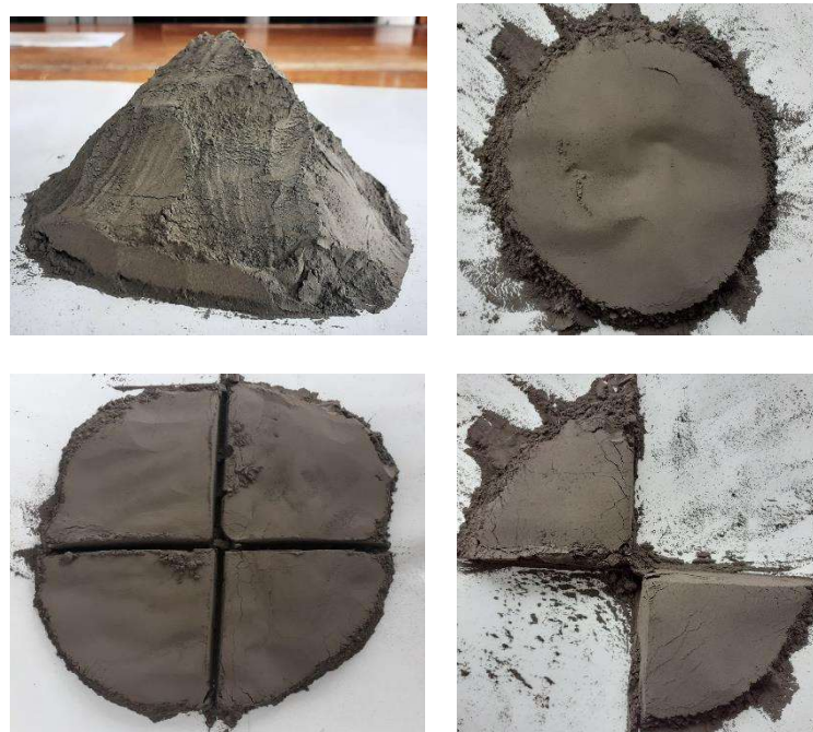
Gambar 3.2 Metode coning dan quartering
