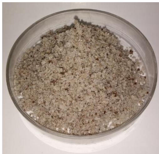
Gambar 3.3 Slag Blast Furnace
