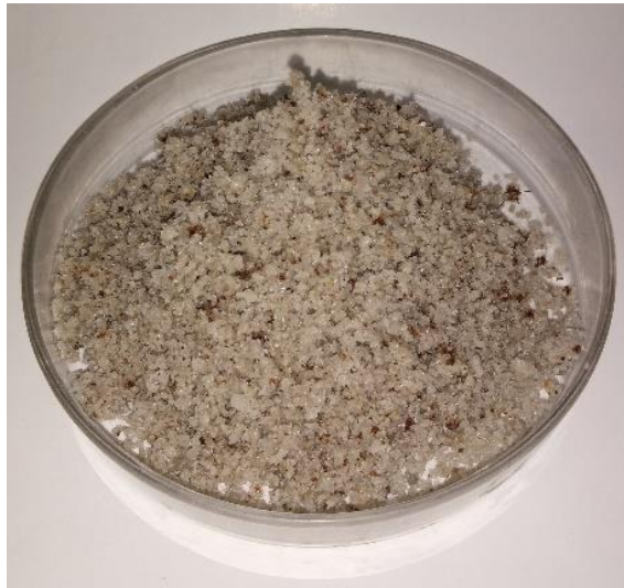
Gambar C.9 Slag Blast Furnace
