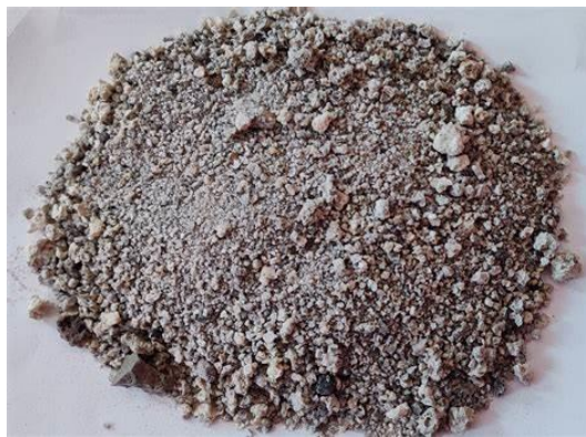
Gambar 2.4 Slag Blast Furnace
