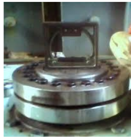
Gambar 3.10 Metode Alignment dengan Presisi (Sumber: Suker Junior, 2022)
