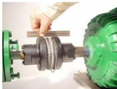
Gambar 3.7 Metode Alignment Dengan Penggaris
