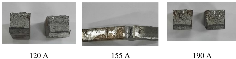
Gambar 4.13 Permukaan Patahan Pada Elektroda E6013 Impor
