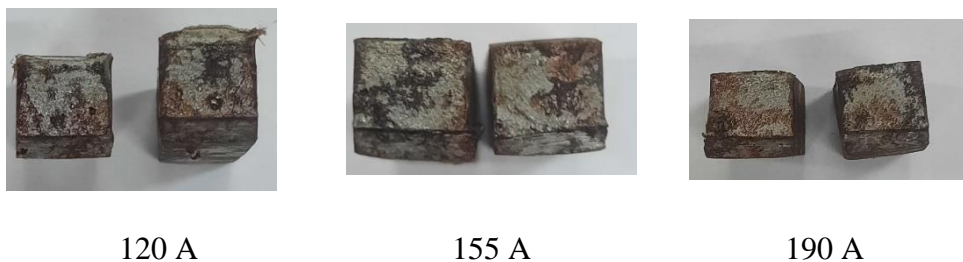
Gambar 4.12 Permukaan Patahan Pada Elektroda E420-13 Lokal
