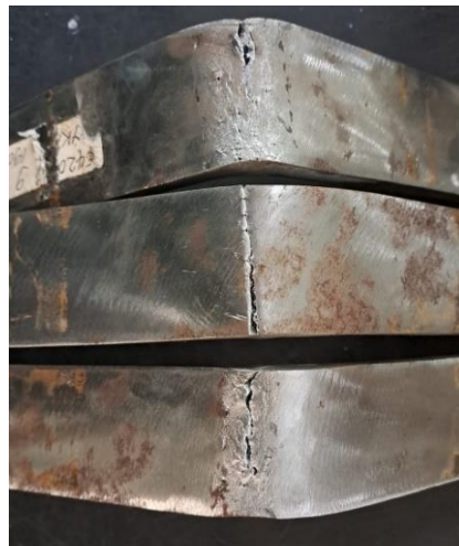
Gambar 4.14 Retak Pada E420-13 Lokal
