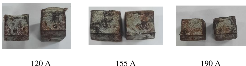
Gambar 4.12 Permukaan Patahan Pada Elektroda E420-13 Lokal
