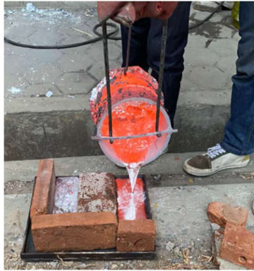
Gambar 3.25 Penuangan AMC yang telah selesai diaduk
