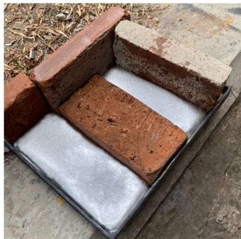
Gambar 3.26 Pendinginan AMC yang telah dituang
