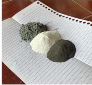
Gambar 3.19 Penyiapan bahan serbuk penguat
