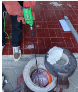
Gambar 3.22 Pengadukan Aluminium Cair (sumber: Pribadi)
