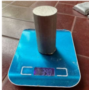
Gambar 3.18 Penimbangan Alumunium (sumber: Pribadi)
