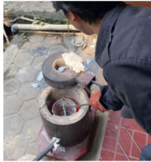
Gambar 3.21 Pengangkatan Terak (sumber: Pribadi)
