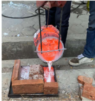
Gambar 3.25 Penuangan AMC yang telah Selesai diaduk (sumber: Pribadi)
