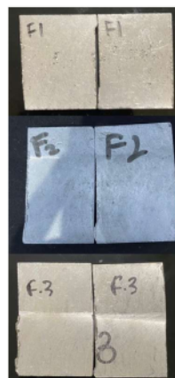
Gambar 4.7 Spesimen Uji Kekerasan Sebelum Pengujian
