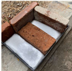
Gambar 3.26 Pendinginan AMC yang Telah Dituang (sumber: Pribadi)
