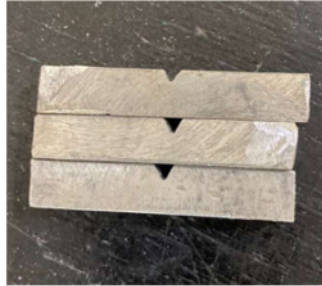
Gambar 4.12 Spesimen Uji Impak Sebelum pengujian (sumber: Pribadi)
