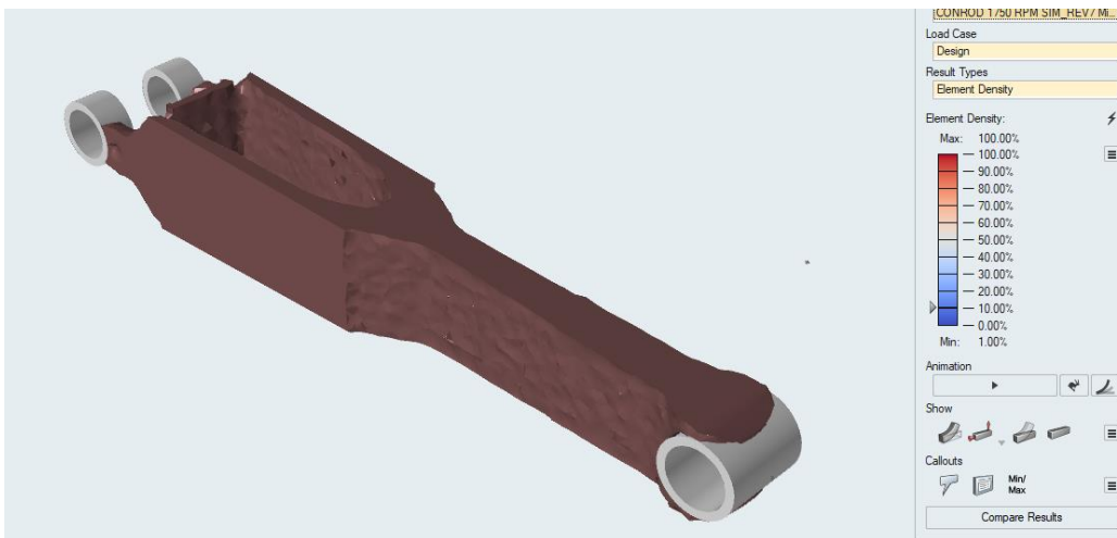
Gambar 4.20 Hasil Optimasi pada Simulasi 1750 Rpm menggunakan Altair Inspire 2019.2
