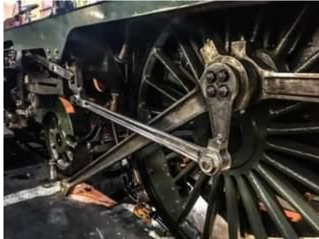
Gambar 2.11 Connecting Rod pada Roda Kereta Api, yang digerakan oleh Hasil Uap dari Batu Bara
