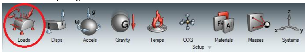
Gambar 4.5 Perintah Loads untuk Menginput Gaya-Gaya Yang Terjadi Pada Benda Uji ( Connecting Rod )
