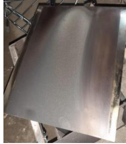
Gambar 4.20 Pelat Fliter ESP setelah melakukan penyaringan
