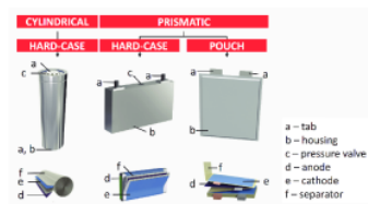
Gambar 2.14 Bentuk-bentuk baterai lithium-ion
