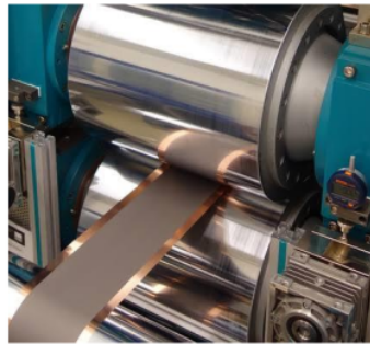
Gambar 2.8 Proses Calendaring Pada Manufaktur Baterai Lithium-Ion (Sumber: Till Günther, 2019)
