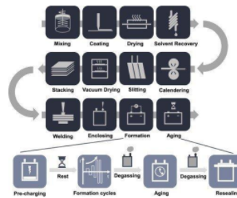
Gambar 2.13 Tahapan cycles Pada Proses Formation
