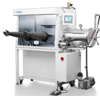
Gambar 2.10 Penggunaan Glove Box Untuk Perakitan Baterai
