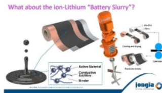
Gambar 2.3 Proses pembentukan slurry melalui tahapan mixing
