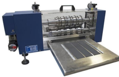
Gambar 2.9 Proses Slitting Pada Manufaktur Baterai Lithium-Ion
