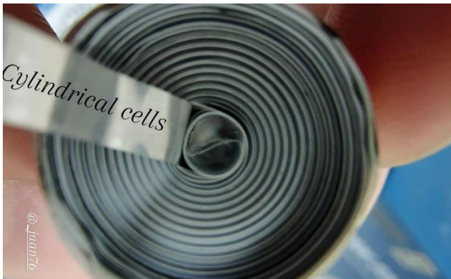
Gambar A.3 Baterai Silinder dengan Katoda \text{LiNi}_{0,5}\text{Mn}_{0,4}\text{Co}_{0,1}\text{O}_2
