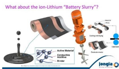
Gambar 2.3 Proses pembentukan slurry melalui tahapan mixing (Sumber: www.jongiamixingtechnology.com )
