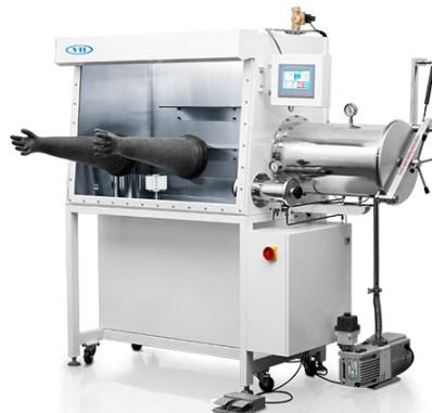
Gambar 2.10 Penggunaan Glove Box Untuk Perakitan Baterai
