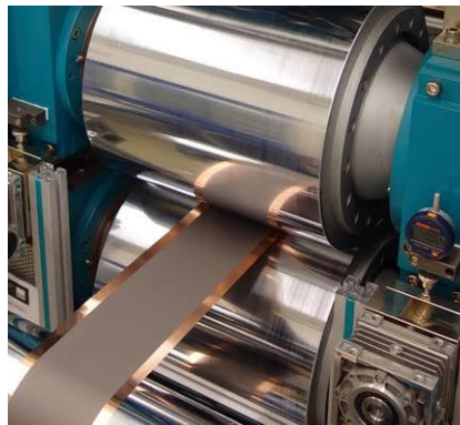
Gambar 2.8 Proses Calendaring Pada Manufaktur Baterai Lithium-Ion (Sumber: Till Günther, 2019)
