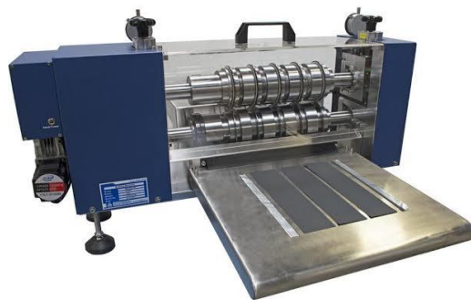
Gambar 2.9 Proses Slitting Pada Manufaktur Baterai Lithium-Ion
