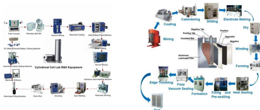
Gambar 2.15 Proses Manufaktur Baterai Lithium-Ion Berbentuk Silinder dan Prismatik
