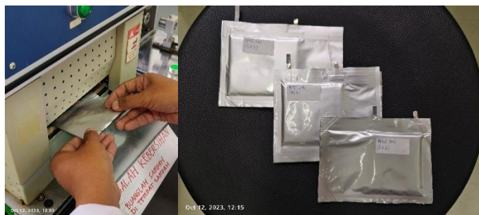
Gambar A.4 Hot sealing baterai
