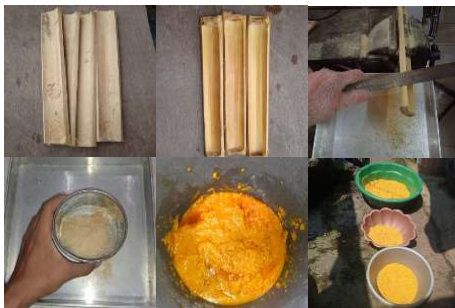
Gambar C.2 Proses Pembuatan Serbuk dan Serat Bambu
