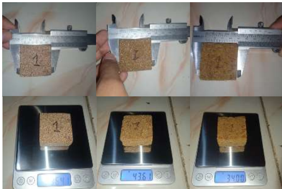
Gambar C.8 Proses Pengujian Daya Serap Air, Pengembangan Tebal, dan Pengembangan Volumetrik
