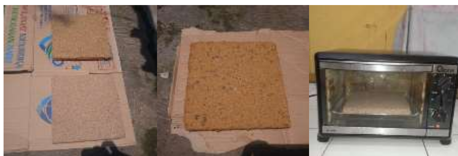
Gambar C.6 Proses Penjemuran dan Curing Papan Partikel
