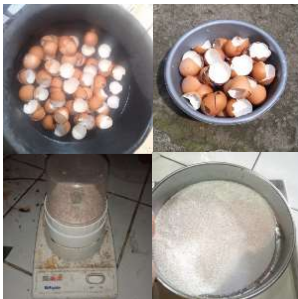
Gambar C.1 Proses Pembuatan Serbuk Cangkang Telur
