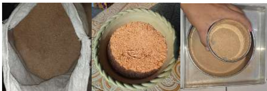
Gambar C.3 Proses Pembuatan Serbuk Kayu Sengon
